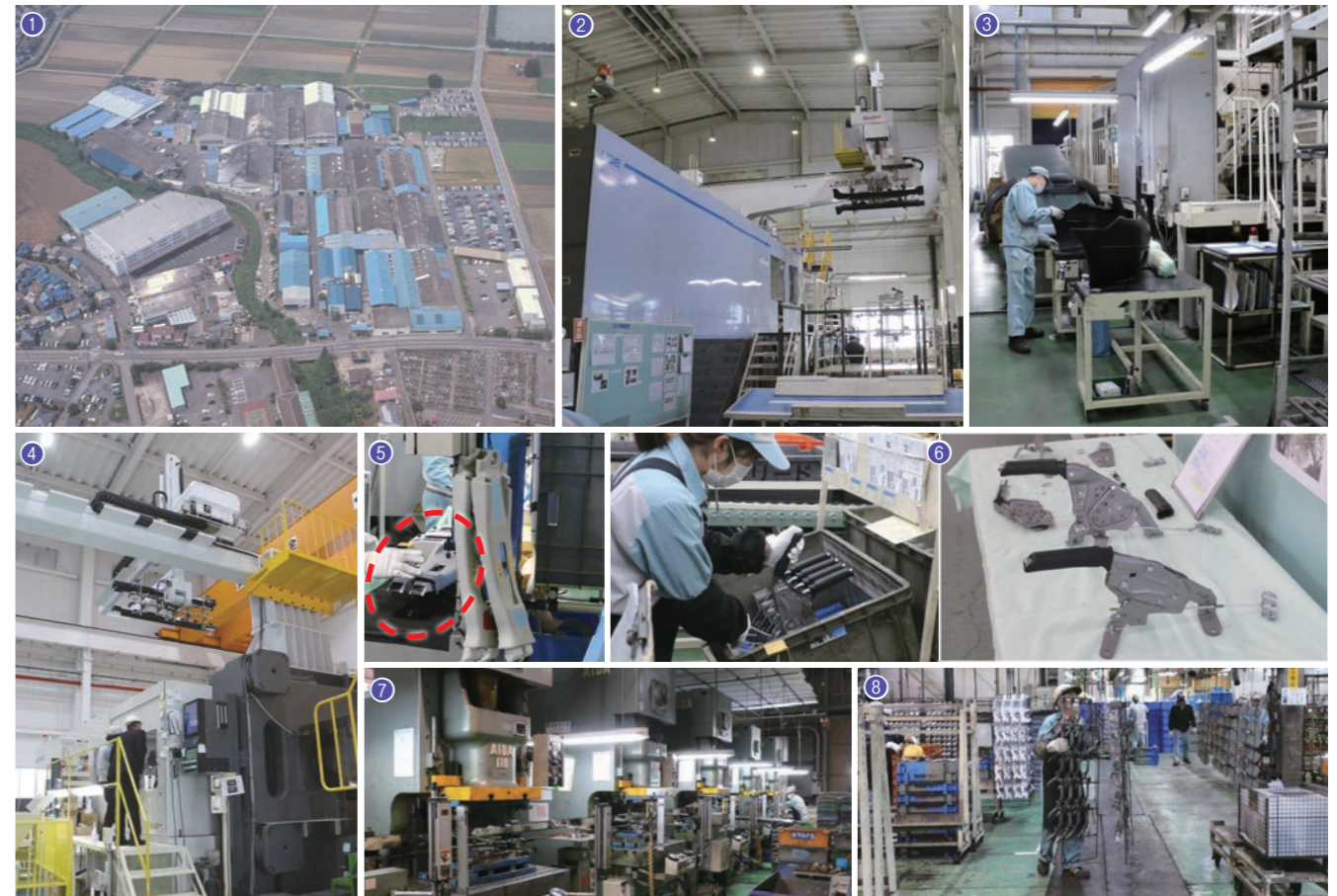
①本社工場は約57,137㎡の広大な敷地面積を誇る。②2013年に導入された電動大型樹脂成形機（3,000t）③こちらも2013年導入の油圧式大型樹脂成形機（3,000t）。前後バンパーやサイドスポイラーなど大型パーツを製造。別棟の塗装工場で塗装もしている。④本社工場内では450t～3000tまで計15基の樹脂成形機が稼働。⑤品質管理も常に厳しく行っている。これは専用カメラを用いて内装パーツ裏のクリップが正しく取り付けられているかチェックしているところ。⑥重要保安部品であるハンドブレーキ。スバル車のハンドブレーキはすべてリードの工場ですべてアッセンブリー化されている。⑦⑧ブレーキペダル等の金属部品の成形・電着塗装も行っている。
