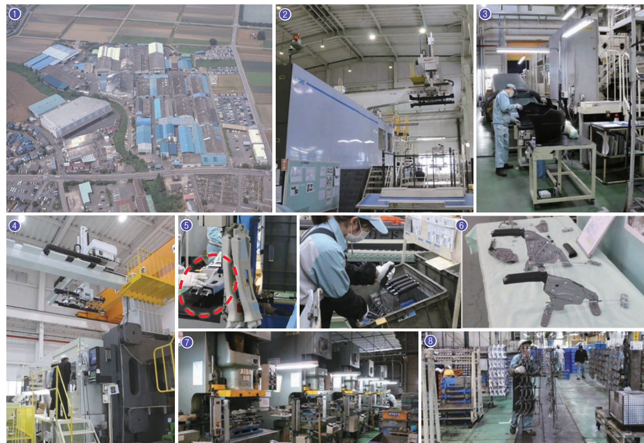
①本社工場は約57,137㎡の広大な敷地面積を誇る。②2013年に導入された電動大型樹脂成形機（3,000t）③こちらも2013年導入の油圧式大型樹脂成形機（3,000t）。前後バンパーやサイドスポイラーなど大型パーツを製造。別棟の塗装工場でも塗装もしている。④本社工場内では450t～3000tまで計15基の樹脂成形機が稼働。⑤品質管理も常に厳しく行っている。これは専用カメラを用いて内装パーツ裏のクリップが正しく取り付けられているかチェックしているところ。⑥重要保安部品であるハンドブレーキ。スバル車のハンドブレーキはすべてリードの工場ですべてアッセンブリー化されている。⑦⑧ブレーキペダル等の金属部品の成形・電着塗装もしている。
