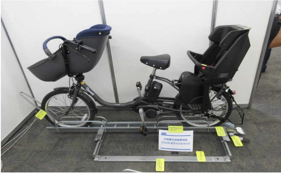
子供乗せ大型自転車対応スライド式サイクルラック ※近年特に増加している子供乗せ電動アシスト自転車を収容できます。
