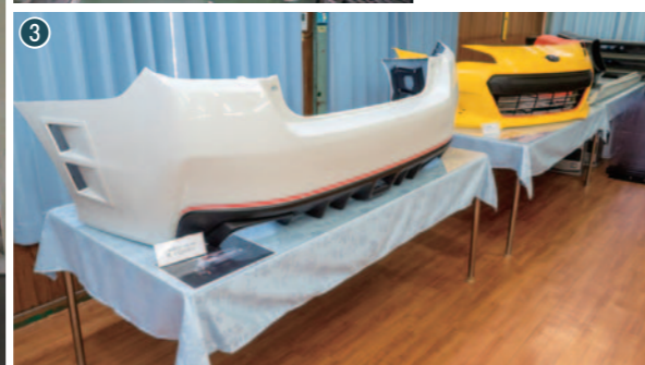
① 2013年導入の電動大型樹脂成形機(3,000t) ② 油圧式大型樹脂成形機(3,000t)。こちらも2013年に導入された ③ 樹脂成形機で製造された樹脂バンパー。約5kgと軽量
